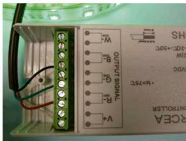
Conexión de salida. El común para los colores es el positivo (cable blanco). Hay 2 terminales para cada conexión.
